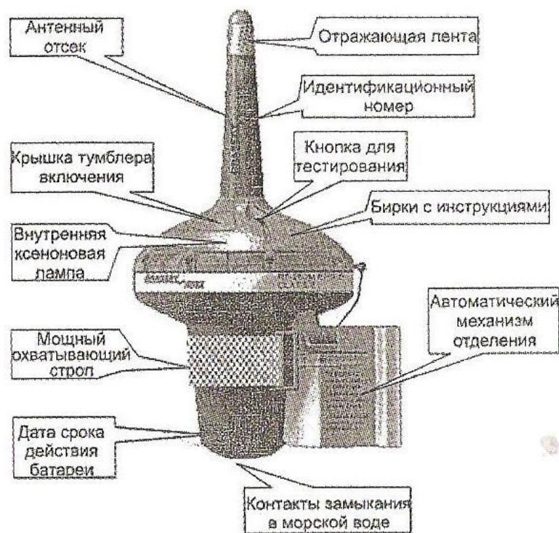
Рисунок 1 - Устройство АРБ-406 типа 260RT с механизмом крепления.
